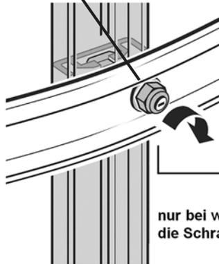
nur bei waagrechttem Schlitz ist die Schraube sicher verriegelt
